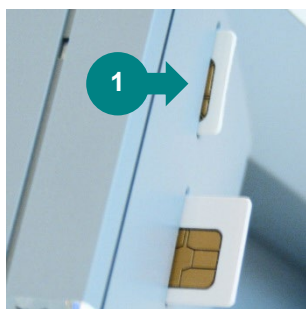
Abbildung 26: Einsetzen der SMC-Karten in die Kontaktiereinheit 3 und 4
