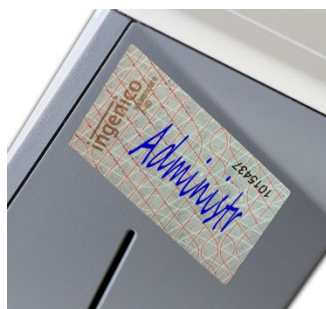
Abbildung 27: Die richtige Positionierung des Slotsiegels
