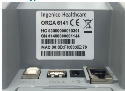
Abbildung 8: Beispiel - Typenschild mit zulässigem Herstellcode HC 03000000010301 oder HC 03000000020301
